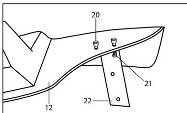
Установите на защитный кожух (12) нож (22) для подрезки триммерной лески.
