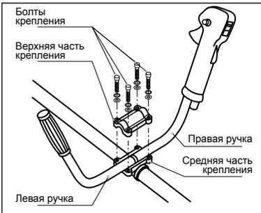
Для крепления рукоятки управления к штанге используется узел крепления. Он состоит из верхней части, крепежных болтов, нижней и средней частей крепления, расположенных на штанге.
