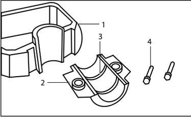
Установите в крышку рукоятки два резиновых амортизатора из комплекта поставки, как показано на рисунке.
